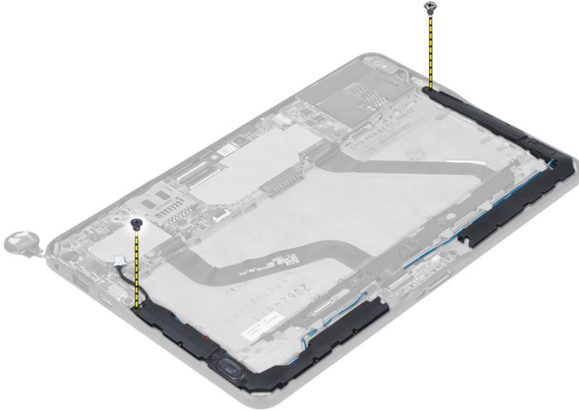
5. Trennen Sie die Lautsprecherkabel auf die Seite des Computers und heben Sie es an, um den Lautsprecher vom Computer zu lösen.
